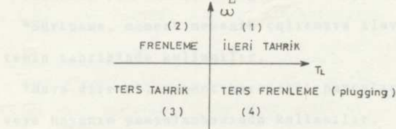
Şekil.3.3 Dört bölgeli çalışmada moment hız diyagramı.
