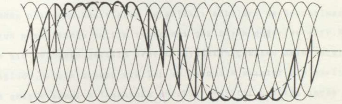
Şekil.III.26.Doğrudan frekans çevirici çıkış fazı gerilim dalga şekli.
