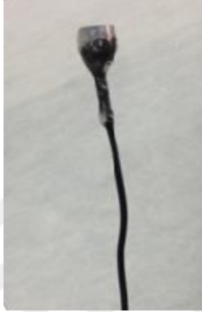
Şekil 5. 3 Kompozitlerin bakır tele katı kontakt ile tutturularak elektrot haline getirilmesi
