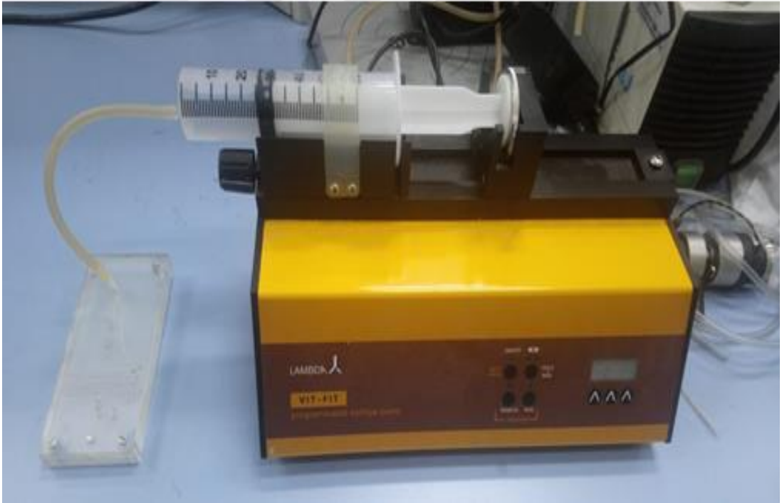
Şekil 6. 15 Akış hücrelerinin sızdırmazlık testi
