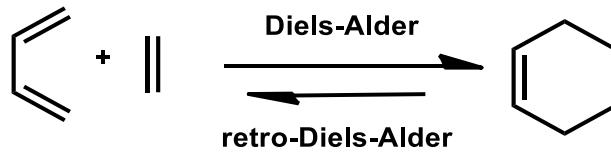
Şekil 1.1 Diels-Alder / Retro Diels-Alder reaksiyonlarının genel mekanizması
