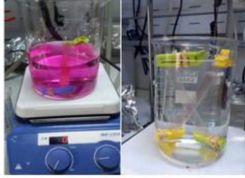
Şekil 4.13 Tetrazin fonksiyonlu P(NIPAAm-co-AN) polimerin metanole karşı A. diyaliz yapılırken B. diyaliz sonrası
