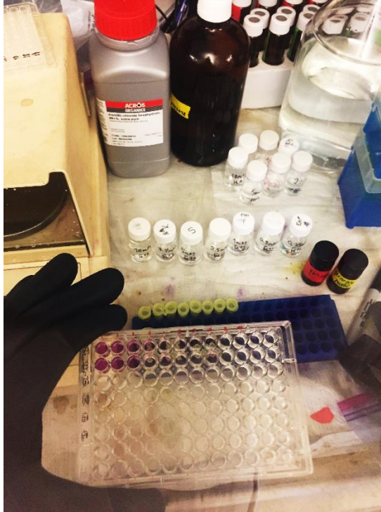
Şekil 3.11 Ferrozin metodu ile örneklerdeki Fe(II) miktarının tayini
