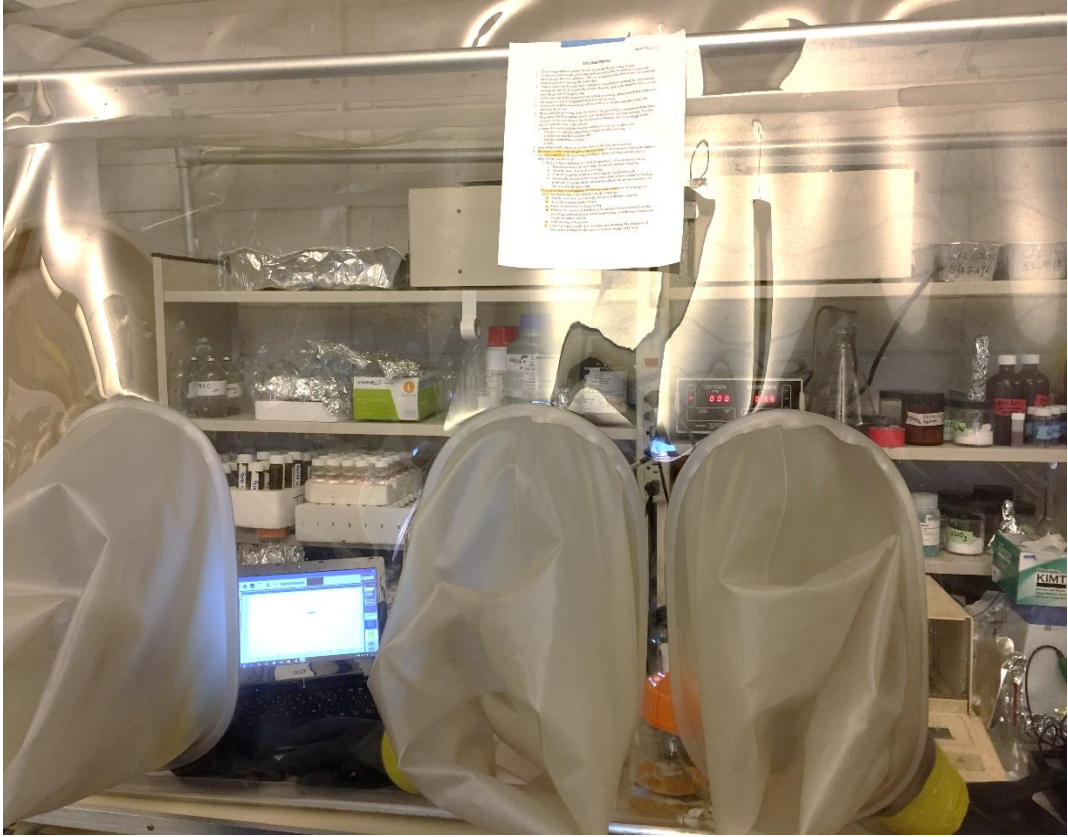
Şekil 3.9 Fe(II)-seçici elektrotların oksijensiz ortamda potansiyometrik testleri
