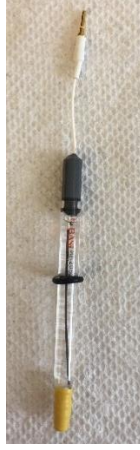
Şekil 3.1 Ag/AgCl referans elektrot (RE)
