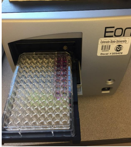
Şekil 3.12 Mikroplatedeki örneklerin spektrofotometrede absorbansının okunması
