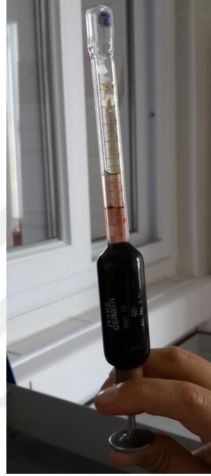
Şekil 2.27 Bütirometre ile sütte yağ analizi
