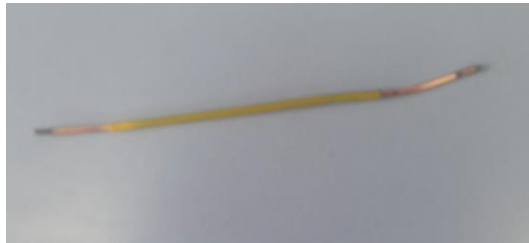
Şekil 3.3 Borulara doldurulmuş olan pH elektrot materyalin sıkıştırılması
