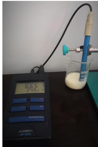
Şekil 3.8 Süt örneklerinin pH metre ile ölçümü
