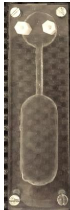
Şekil 4.96 Sütte yağ analizinin yerinde yapılabilmesi için tasarlanan lab-on-çip
