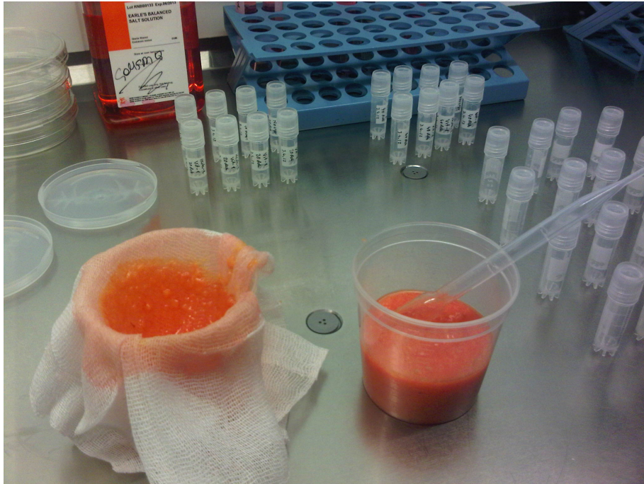
Şekil 3.5 İşlemden önce lipoaspirat örneğinin süzülmesi
