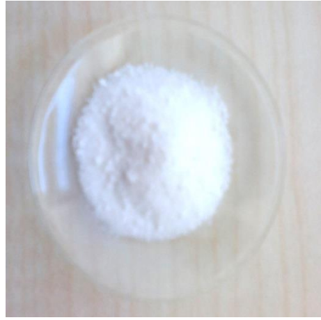
Şekil A. 11 Buğday kabuğu külü silikası ile sentezlenen zeolit NaA (Z4)
