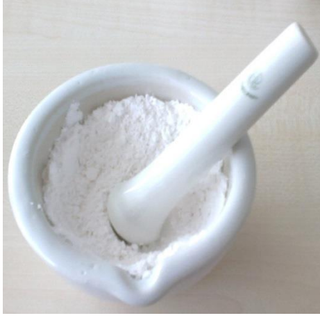
Şekil A. 11 Buğday kabuğu külü silikası ile sentezlenen zeolit NaA (Z4)
