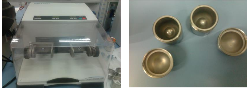
Şekil 4. 17 Mekanik öğütücü ve öğütme kapları
