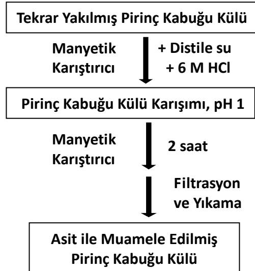
Şekil 4. 20 Tekrar yakılan pirinç kabuğu külüne uygulanan asit muamele işlemi
