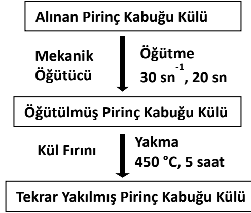
Şekil 4. 19 Alınan pirinç kabuğu külüne uygulanan öğütme ve yakma işlemleri
