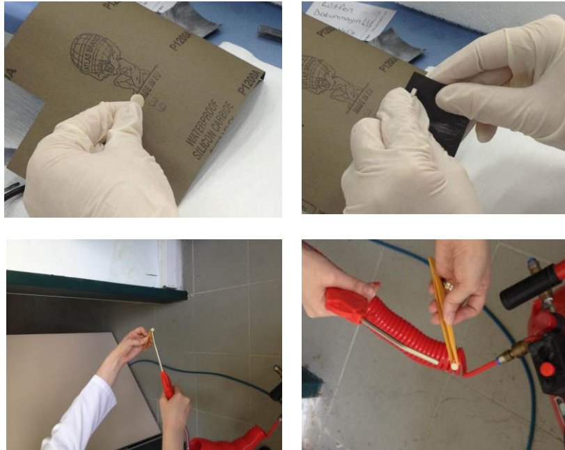
Şekil 4. 30 Su absorpsiyonu ve suda çözünürlük testi için numunelerin hazırlanması
