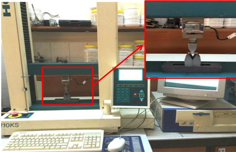
Şekil 4. 16 Universal mekanik test cihazı H10K-S (Hounsfield, İngiltere)
