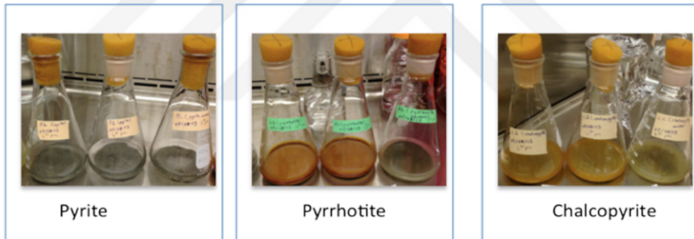
Şekil 3.4 Pirit, pirotit ve kalkopirit minerallerini içeren biyotik ve kontrol erlenlerin 30 günlük biyoliç deneyleri sonucundaki görünümü
