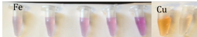
Şekil 3.7 Demir ve bakır iyon konsantrasyonlarının UV-Spektrofotometre ile kolorimetrik olarak tespiti.
