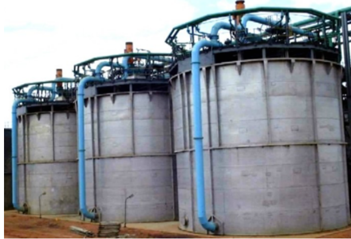
Şekil 2.8 Tank biyoliçi düzeneği [143]
