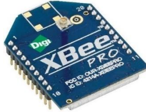
Şekil 3.15 Kablosuz Haberleşme Modülü (XBee)
