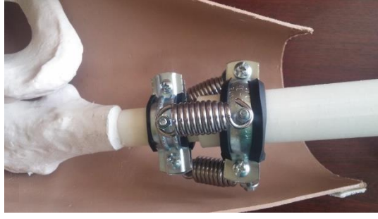
Şekil 3.33 Yaylar Kullanılarak Yumuşak Doku Mekanik Empedansının Modellenmesi
