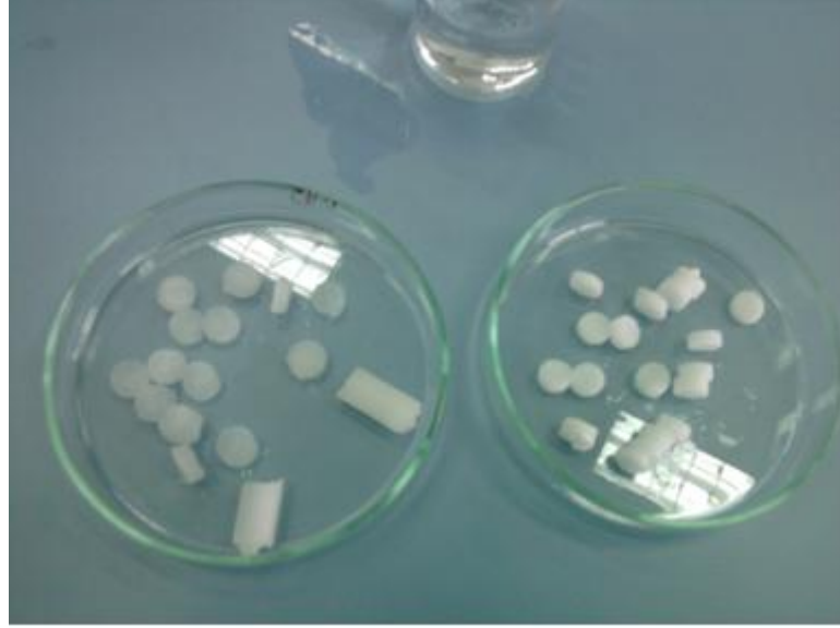
Şekil 3.1 İslakken kesilen kriyojellerin görüntüsü.
