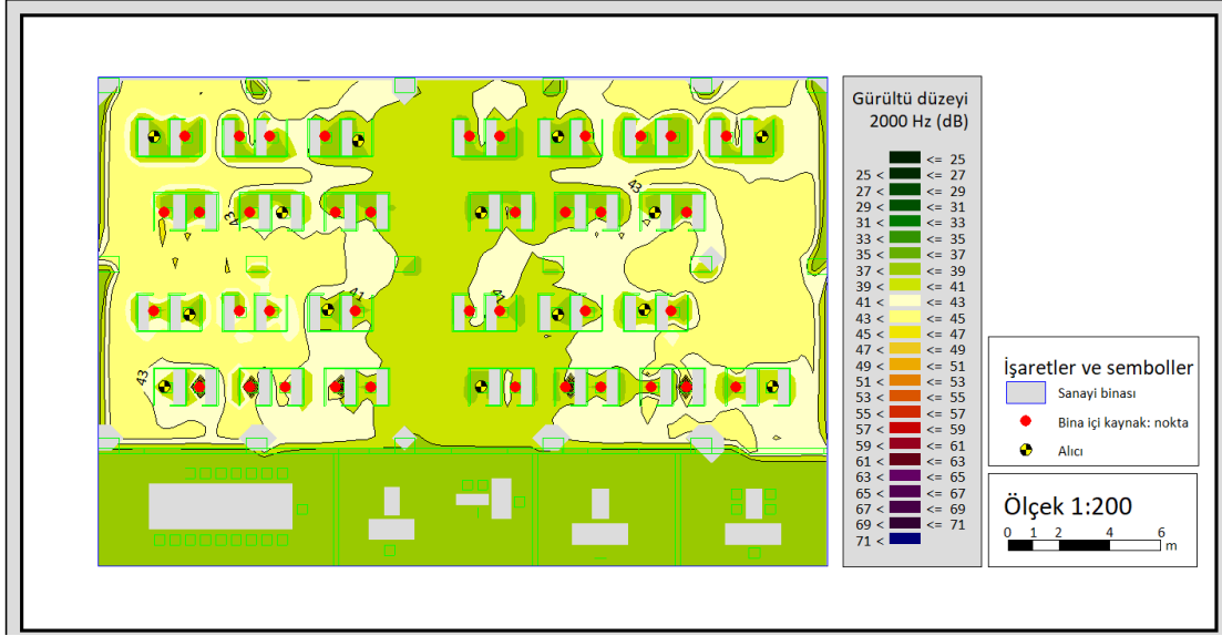
Şekil 4.27 Kurgu 3, 2000 Hz frekans tayfında gürültü düzey dağılımı gürültü haritası
