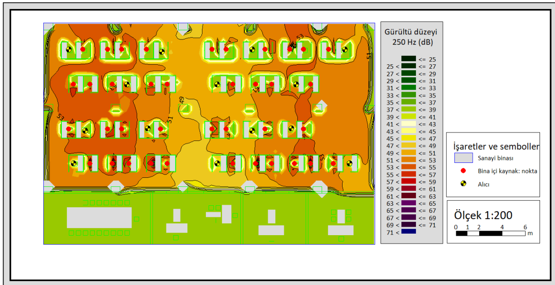
Şekil 4.24 Kurgu 3, 250 Hz frekans tayfında gürültü düzey dağılımı gürültü haritası
