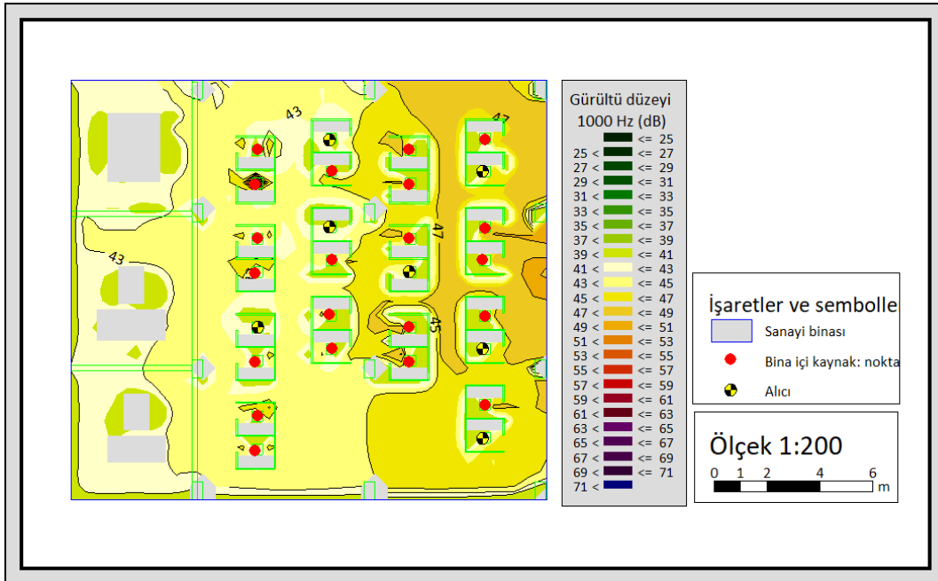
Şekil 4.35 Kurgu 4, 1000 Hz frekans tayfında gürültü düzey dağılımı gürültü haritası
