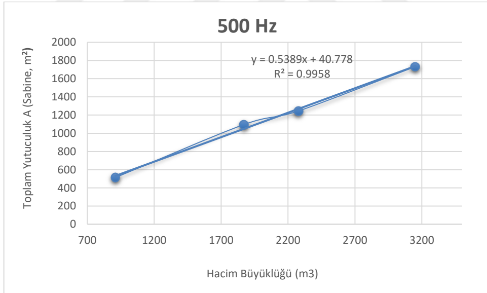
Şekil 4.40 500 Hz frekans oktav bandında hacim büyüklüğüne göre sağlanması gereken toplam yutuculuk değerleri
