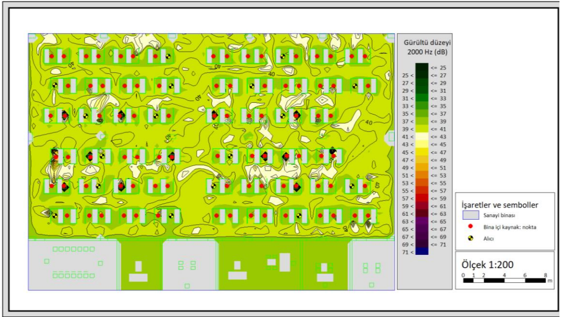
Şekil 4.9 Kurgu 1, 2000 Hz frekans tayfında gürültü düzey dağılımı gürültü haritası
