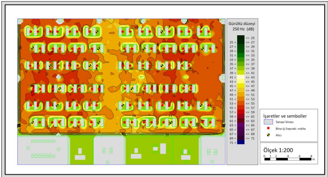
Şekil 4.6 Kurgu 1, 250 Hz frekans tayfında gürültü düzey dağılımı gürültü haritası
