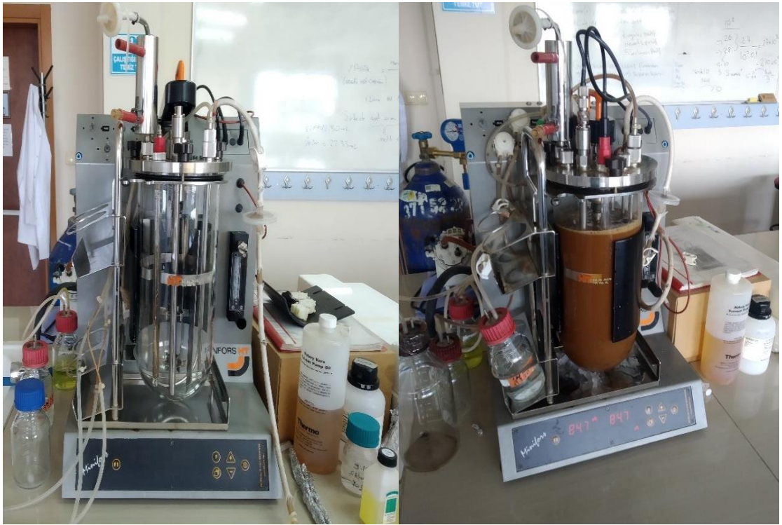
Şekil 2.2 Maya biyokütlesi üretmek için kullanılan biyoreaktör
