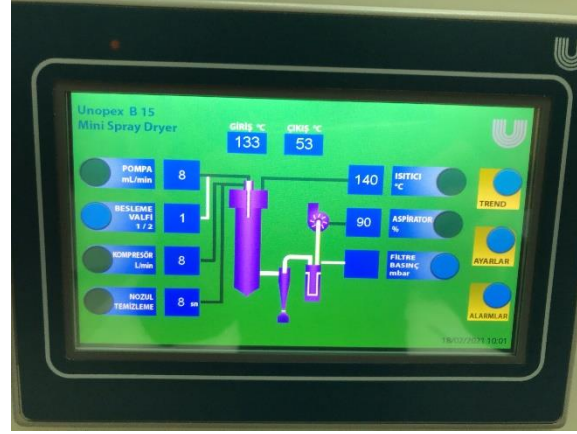
Sprey kurutucu şartlarının ayarlanması
