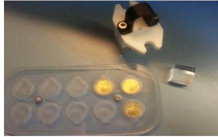
Şekil 5.3 SPR sisteminde kullanılan çipin, prizmanın ve bunların kanala takıldıktan sonraki görüntüsü
