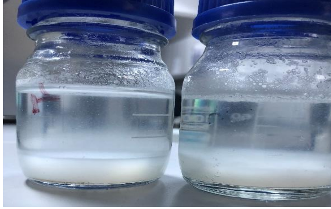
Şekil 4.1 Kitosan partiküllerinin agregasyonu
