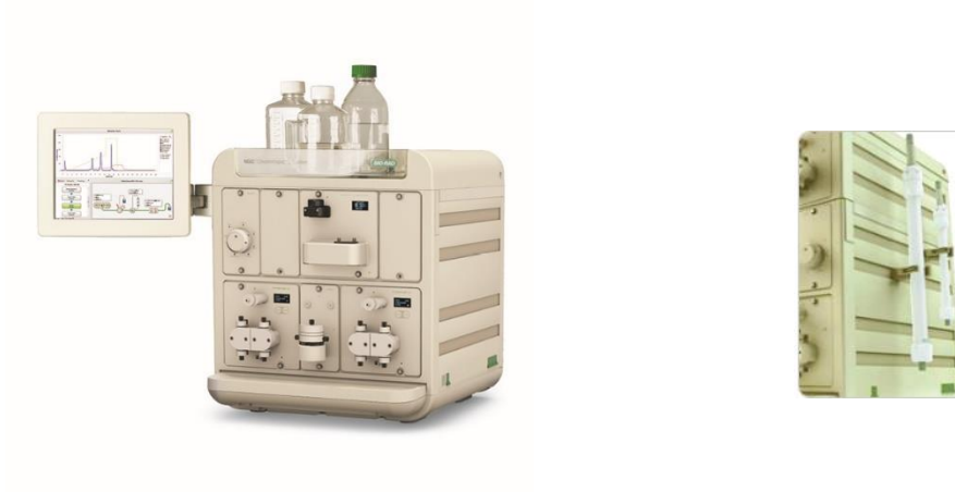
Şekil 2.6 Kolon kromatografi sistemi ve kolon
