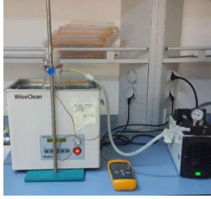
Şekil 3.3 Ultrases destekli vakum kurutma sistemi
