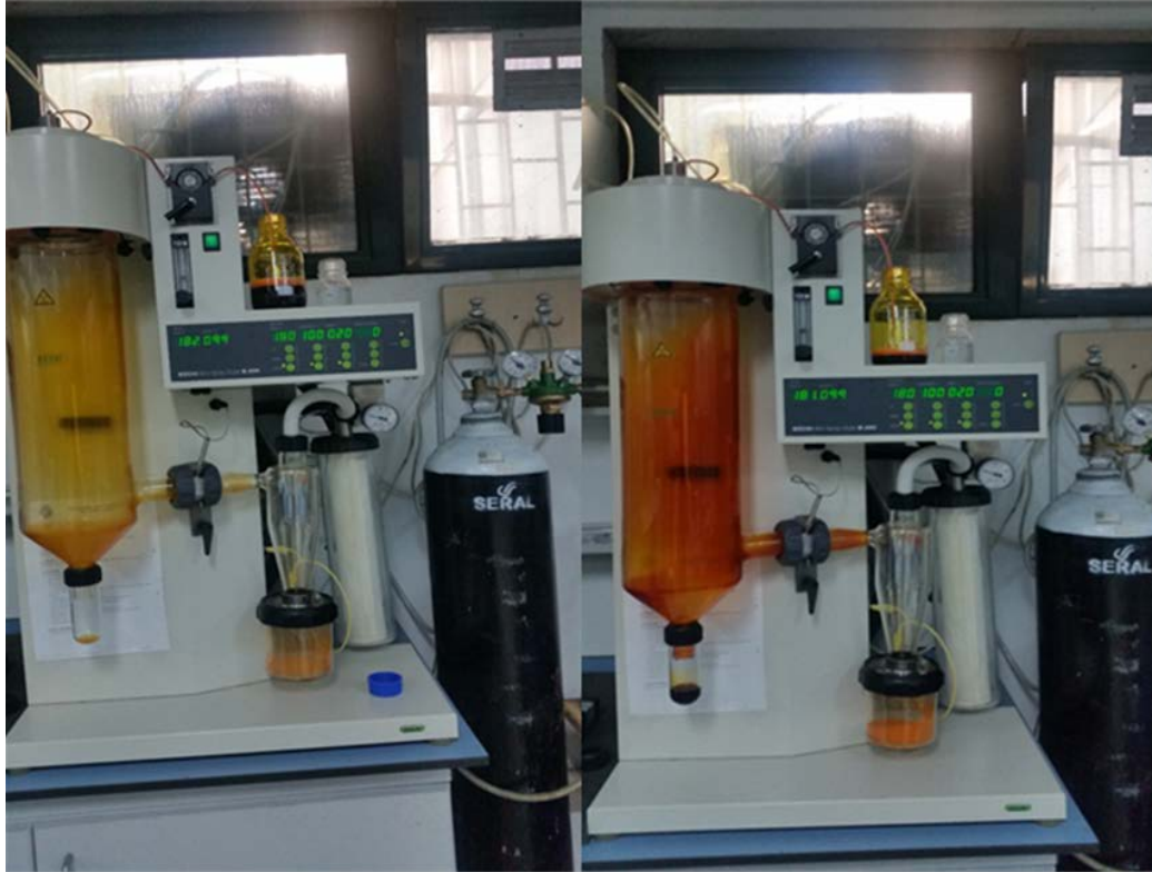
Şekil 3.6 Püskürtmeli kurutucuda mikroenkapsülasyon işlemi görüntüleri
