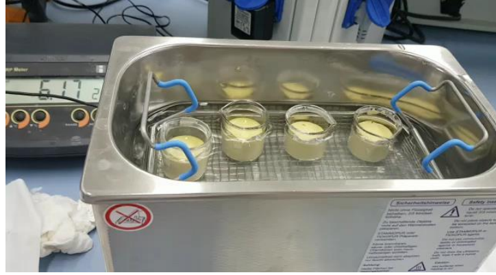
Şekil 2.9 Lantan+Seryum katalizörünün ultrasonik kaplanması
