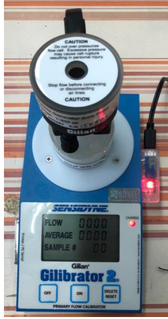
Şekil 4.5 Akış kontrol cihazlarının kalibrasyonunun yapıldığı cihaz
