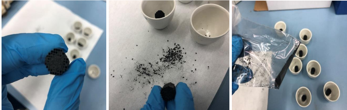
Şekil 2.13 Gözeneği tıkanmış La-Co katalizörünün gözeneklerinin temizlenmesi
