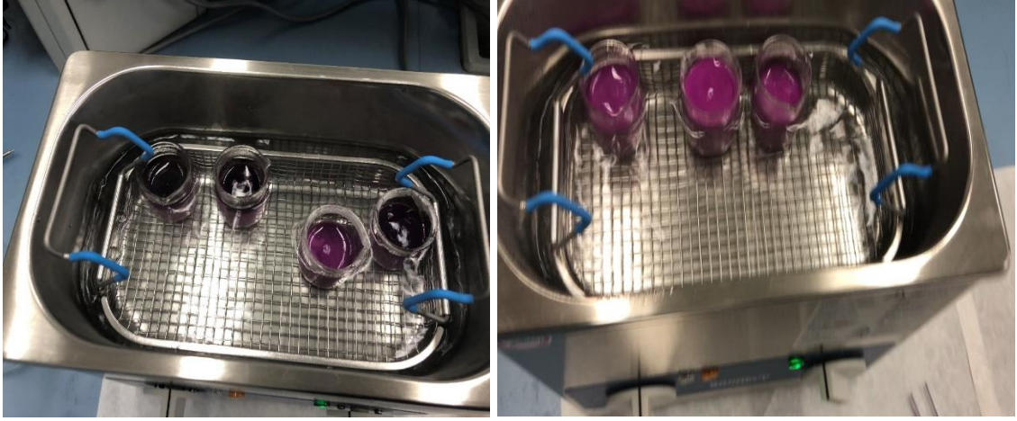
Şekil 2.8 Lantan+ Kobalt katalizörünün ultrasonik kaplanması
