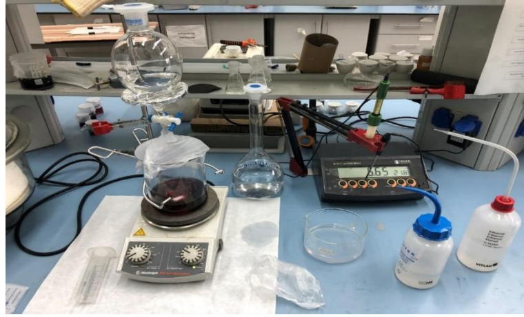
Şekil 2.4 Çözeltinin pH'nın yükseltilmesi ve pH metre ile ölçülmesi
