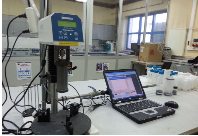
Şekil 2. 15 Eş eksenli tip reometre ve şematik görünümü.
