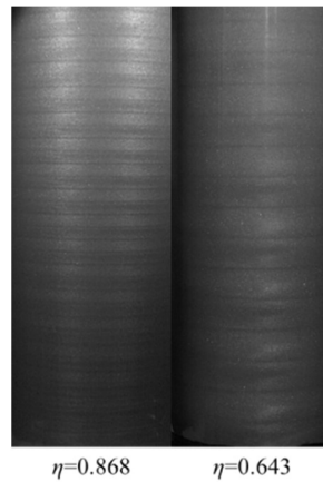
Şekil 8. 3 Farklı çap oranlarında oluşan TVF vorteks yapıları.
