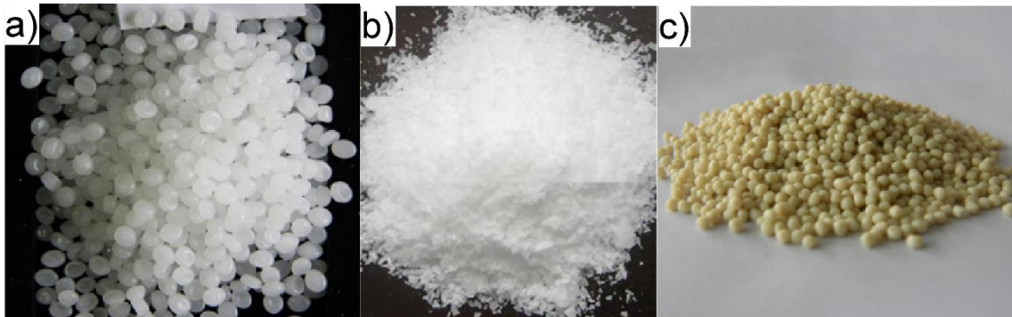
Şekil 5.1 a) PLA granülleri, b) maleik anhidrit, c) termoplastik poliüretan granülleri
