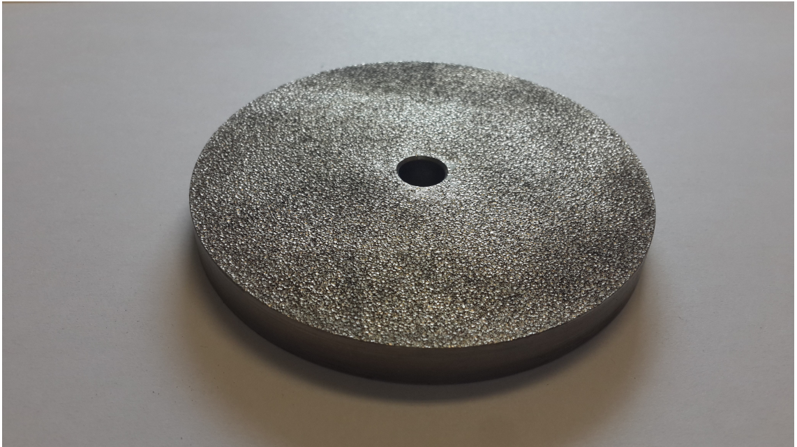
Şekil 2.11 Dalma erozyon ile 45 VDI yüzey pürüzlülüğü elde edilmiş çelik disk
