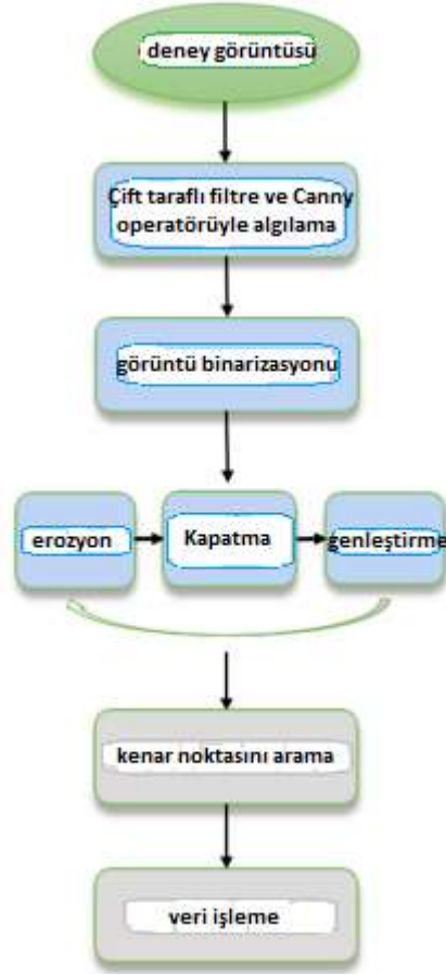
Şekil 2.4 Görüntü işleme programının akış şeması
