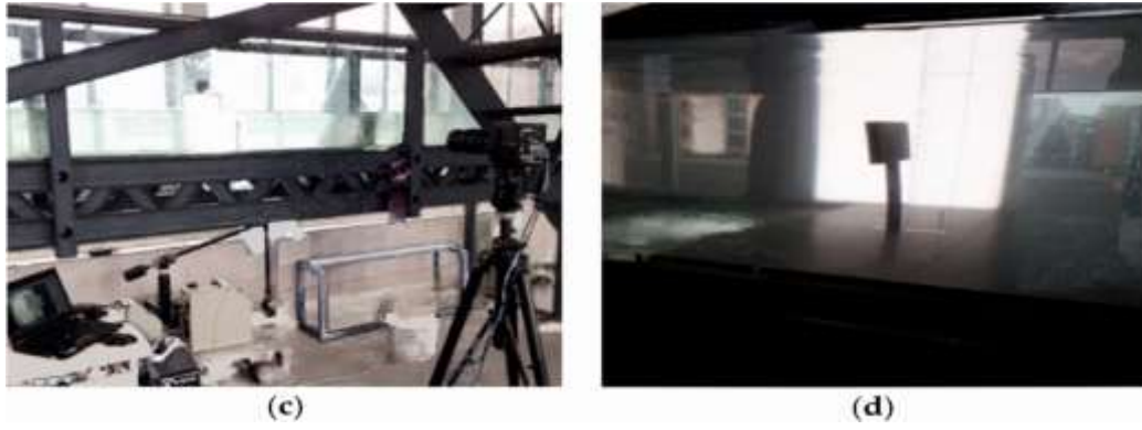
Şekil 2.2 Deney düzeninin şeması: (a) devridaim su kanalında deney düzeni; (b) kanalın bir tarafındaki yüksek hızlı kamera; (c) ve (d) yandan görünüm
