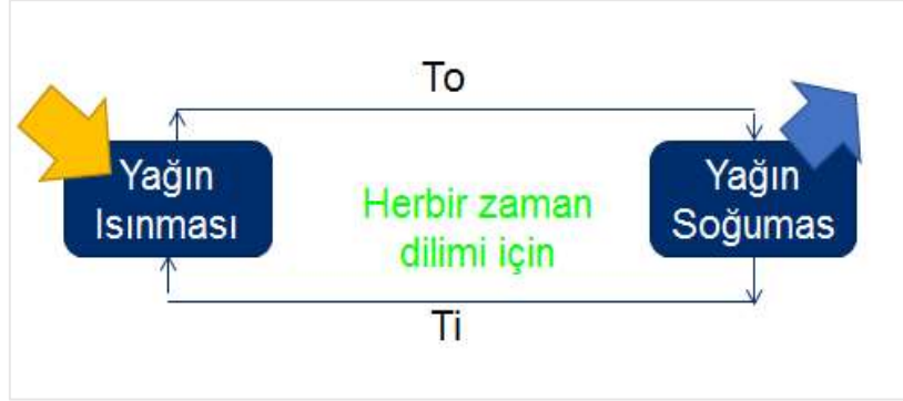
Şekil 3.13 Motor yağına ısınma ve soğuma döngüsünün temeli
