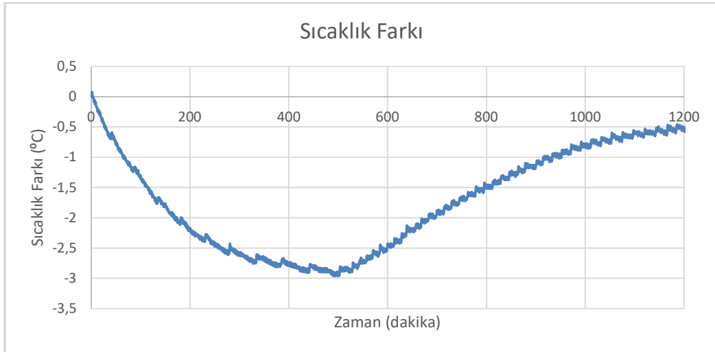
Şekil 4.19 13 L 1500 devir/dakika şartlarında model ve deneysel sonuçlar için sıcak motor yağ sıcaklığı farkları
