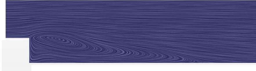
Şekil 4.24 Farklı eksenel akış koşulları ve iç silindir dönüş hızları için ayrılma vorteksi büyüklüğünün değişimi ( Re=20000 )
