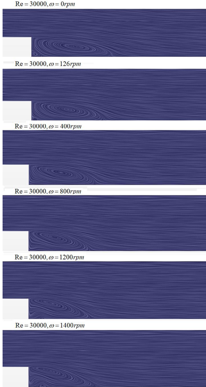
Şekil 4.25 Yüksek Re sayıları için ayrılma vorteksi büyüklüğünün iç silindir dönüş hızıyla değişimi (Re=30000)
