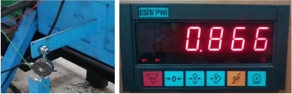
Şekil 5.14. S tip Yük Hücresi ve Esit marka indikatör
