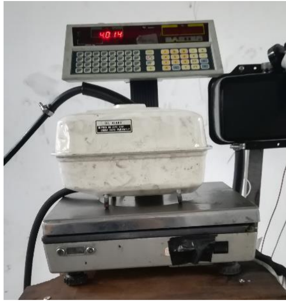
Şekil 5.8. Yakıt sarfiyatının ölçümü yapılan hassas terazinin görünümü
