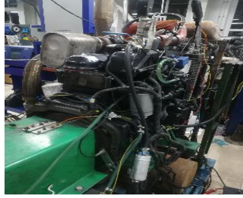
Şekil 5.4 Deney motorunun katalog görünümü ve sete bağı hali
