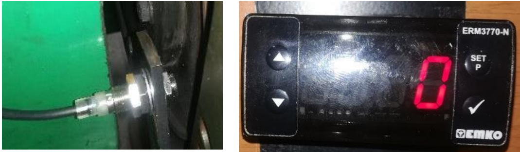
Şekil 4.15 İndüktif devir sensörü ve takometre indikatörü
