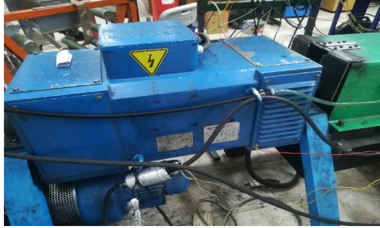
Şekil 5.6 DC dinamometrenin 2 boyutlu görünümü
