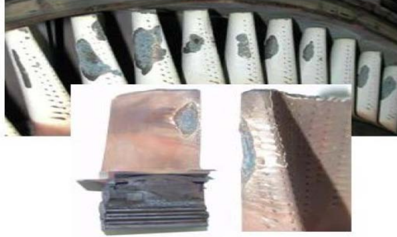
Şekil 3.9 Birinci sıra hareketli kanatta kalkan TBC kaplama ve oksidasyon hasarı [19]
