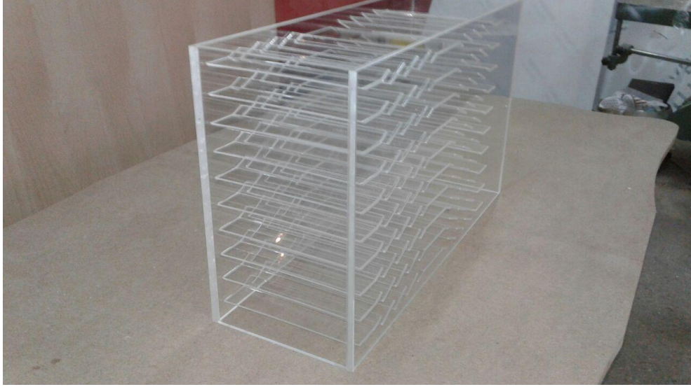
Şekil 3. 2 PIV deneylerinde kullanılan saydam akrilik malzemeden imal edilmiş panjurlu kanat modeli
