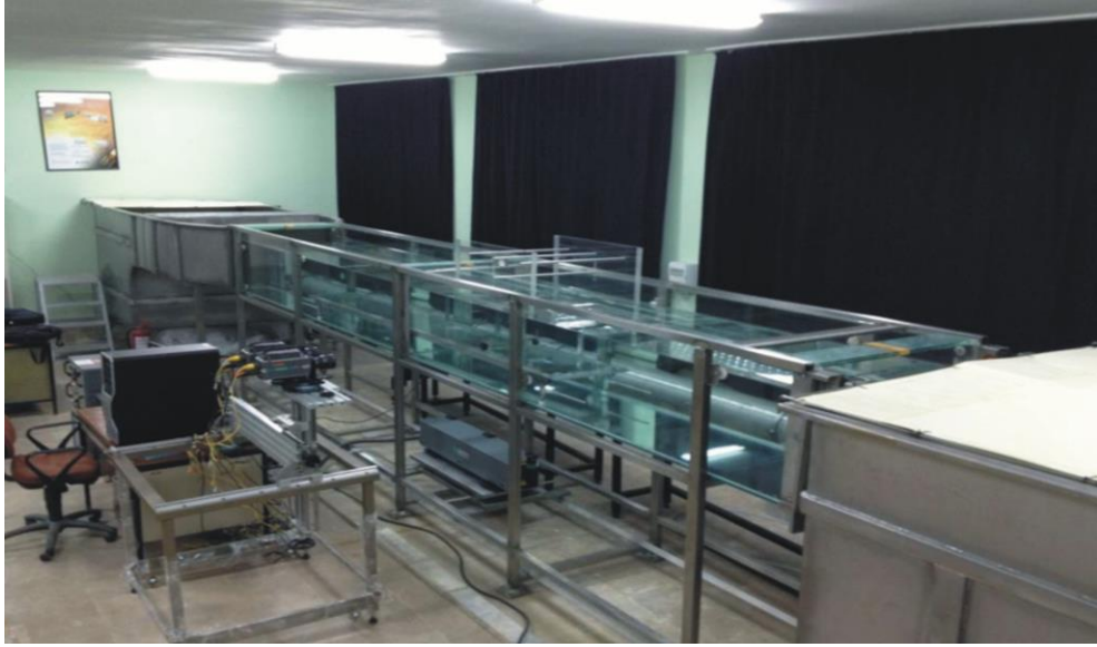
Şekil 3. 1 PIV deneylerinin gerçekleştirildiği kapalı sistem su kanalı ve PIV laboratuvarı (Selçuk Üniversitesi, Makine Mühendisliği Bölümü)
