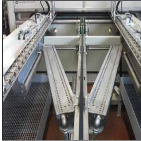
Şekil 3.3 İğne ve zincir tertibatı (Kumaşın kabine girişi)
