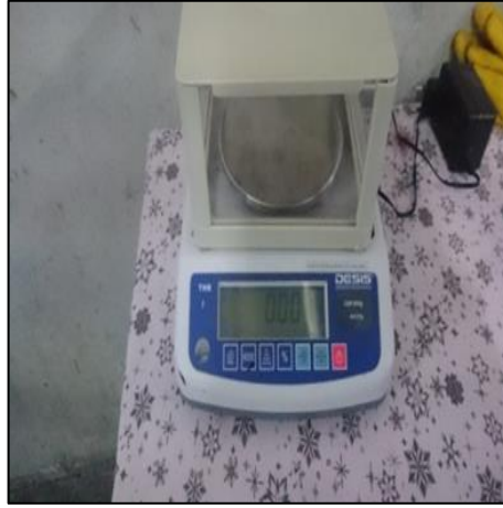
Şekil 3.16 Desis THB 600 hassas terazi
