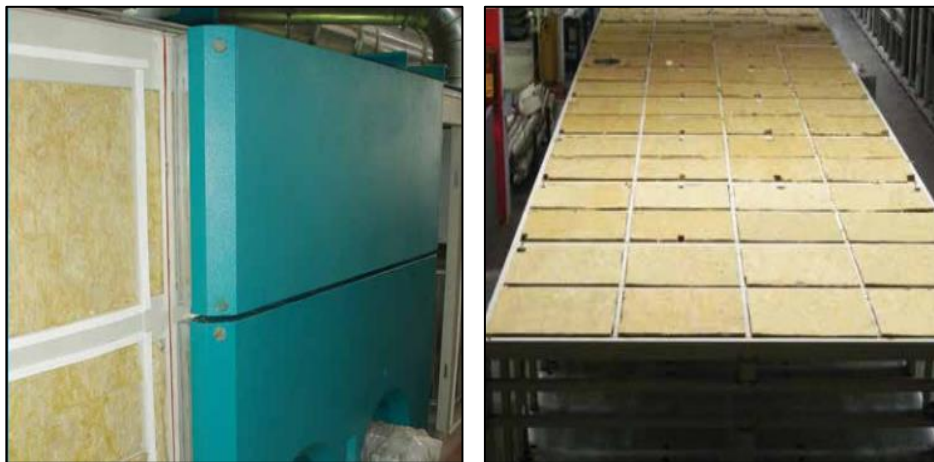
Şekil 3.8 Gövde ve kapaklardaki yalıtım [41]
