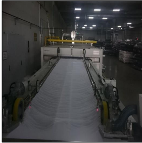
Şekil 3.3 İğne ve zincir tertibatı (Kumaşın kabine girişi)
