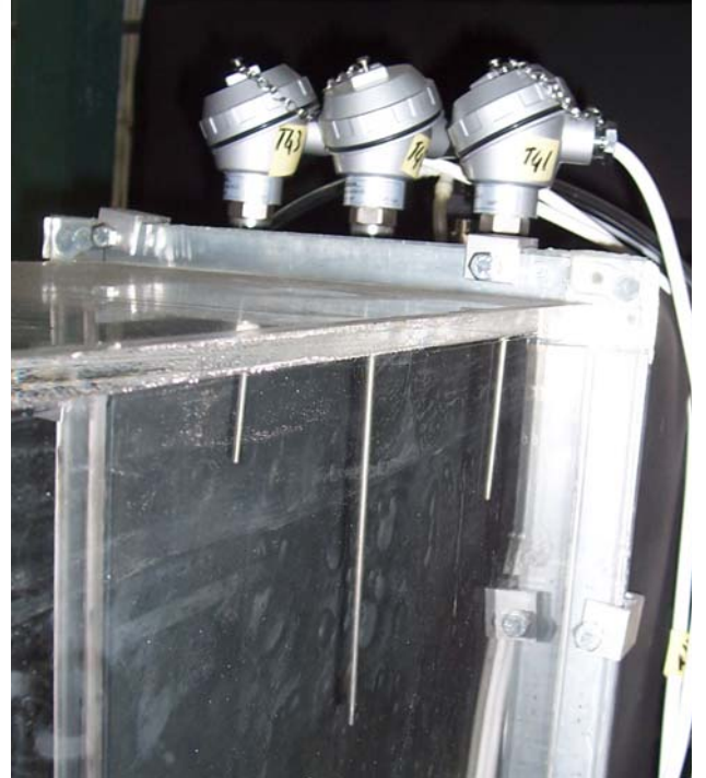
Şekil 3.12 RTD'lerin kanal içindeki yerleşimi
