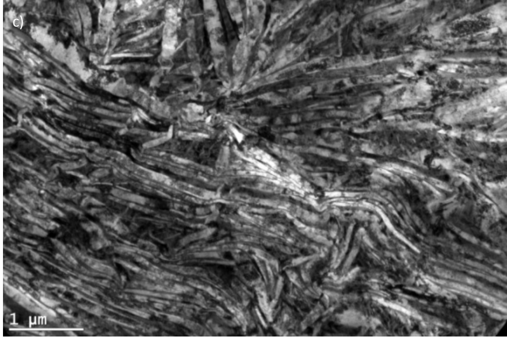
Şekil 3. 39 Aşınma Testi Sonrasında HE16 Numunesi Üzerinden Gerçekleştirilen A) Geçirimli Elektron Mikroskobu Görüntüsü Ve B) TEM Analizinden Elde Edilen Kutup Desenleri C) İlk Haldeki TEM Analizi
