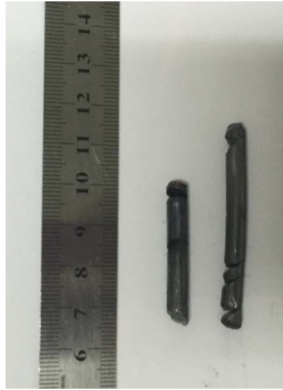
Şekil 4. 10 450 °C'de aşırı plastik deformasyon uygulanan Ti13Nb13Zr numuneler sırasıyla 1-3 paso
