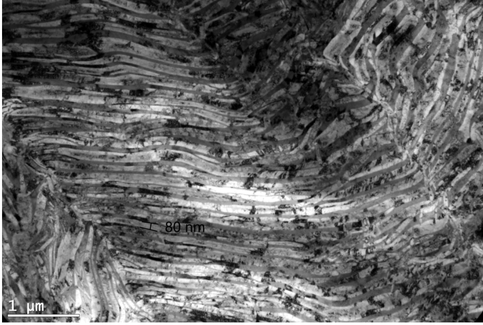
Şekil 3. 24 Ti13Nb13Zr'un Hidrostatik Ekstrüzyon Sonrasın Sahip Olduğu İçyapı-Geçirimli Elektron Mikroskobu İle Elde Edilmiş
