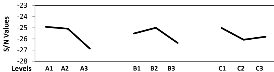
Şekil 3. 83 Sertlik Değerinin Kesitteki Standart Sapmasına Bağlı Olarak Tespit Edilen S/N Grafiği
