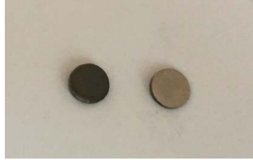
Şekil 3. 19 Tel Erozyon Sonrası Ve Parlatılan Numune Yüzeylerinin Görüntüleri
