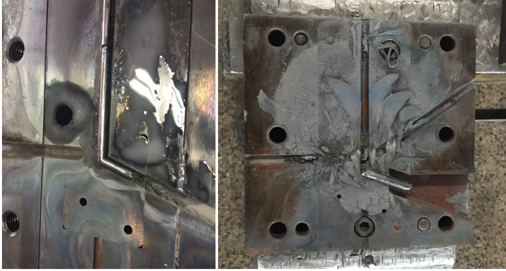
Şekil 4. 11 a) Uzun Numuneler İçin Kullanılan Kalıbın Pim Kırılması Sonrası Kalıp Görüntüsü b) Kısa Numuneler İçin Kullanılan Kalıbın Aşınması Sonrası Kalıp Görüntüsü
