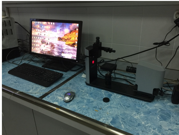
Şekil 3. 12 ThetaLite Temas Açısı Ölçüm Cihazı Yüzey Temas Ölçüm Cihazı
