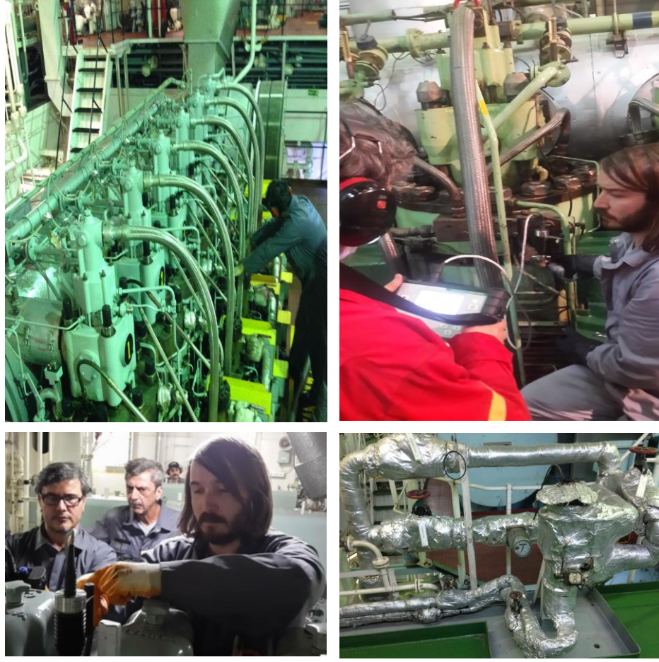
Şekil 4. 3 Performans (güç ve yakıt sarfiyatı) verilerinin alınması
