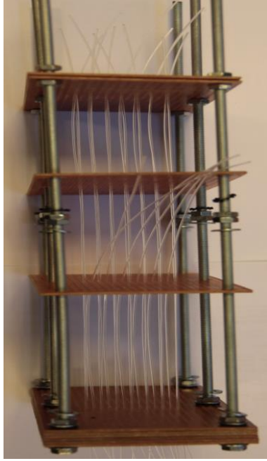
Şekil 5.28 Dokunma hissi algılayıcısı deney düzeneği üretimi öncesi üretilen son prototip
