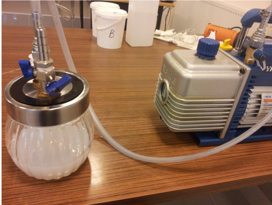
Şekil 6.2 Döküm öncesi silikon karışımın hazırlanışı: Vakumlama sistemi bir vakum pompası ile karışımdaki hapsolan havayı dışarı tahliye edilmesi
