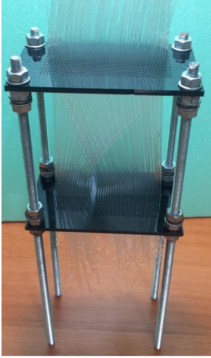
Şekil 7.2 Algılayıcı fiber optik kablo dizimi
