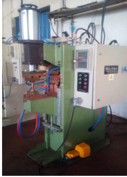
Şekil 4.6 Mistaş Firması 'MPR3-120kVA' Model Punta Kaynak Makinası
