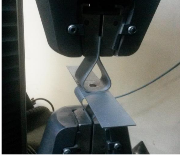
Şekil 4.57 Üçlü sac numunelerinin çekme testlerinin gerçekleştirilmesi
