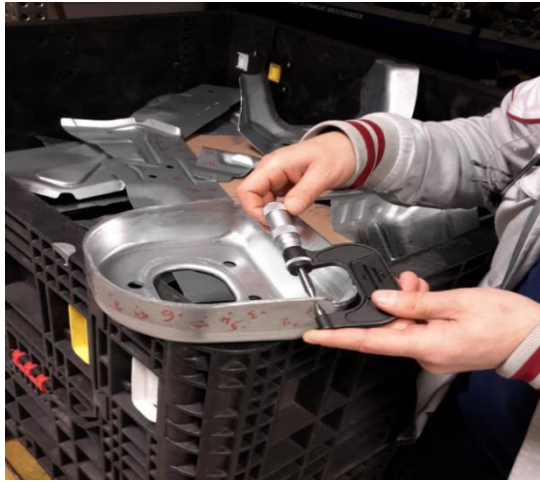
Şekil 4.52 Kritik kalınlıkların ölçümü
