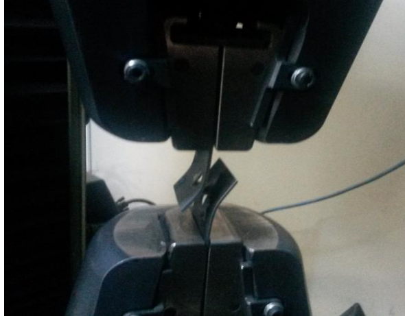
Şekil 4.56 Numunelerin sıyırma testlerinin gerçekleştirilmesi
