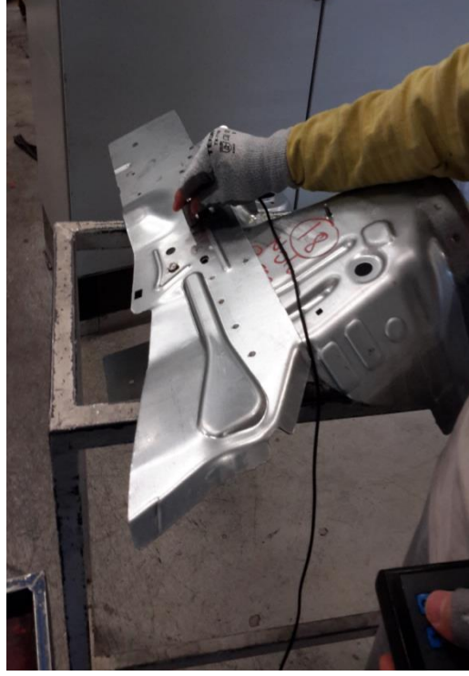
řekil 4.50 Komplelere Ultrasonik Test uygulama rneęi
