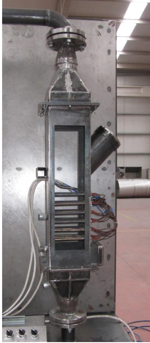
Şekil 2.4 Kurutucu bölümün fotoğrafı
