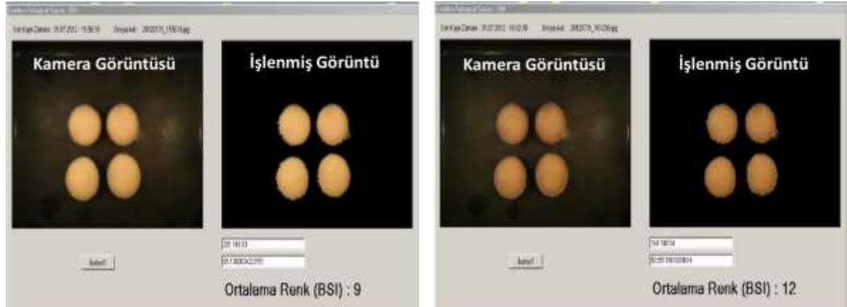
Şekil 4. 19 Fırın içinden gerçek zamanlı renk ölçümü
