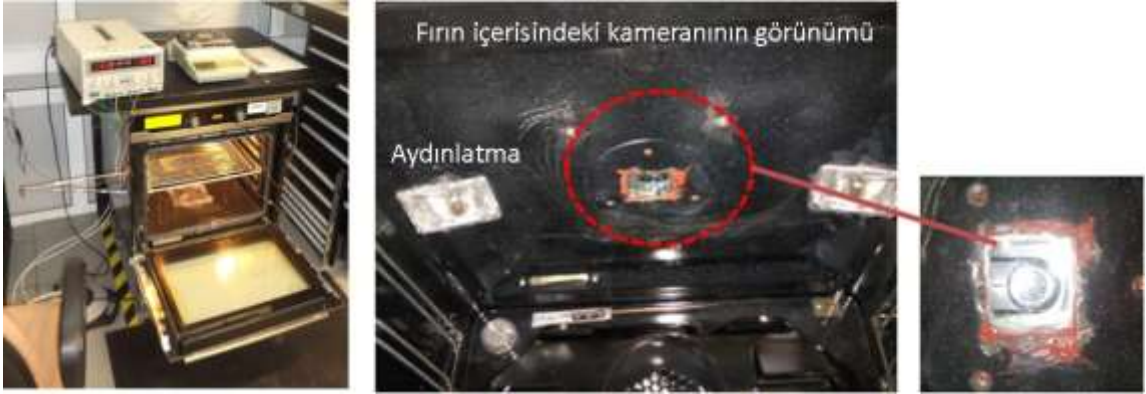
Şekil 4. 17 Fırın üst duvarına yerleştirilen kamera ve aydınlatma
