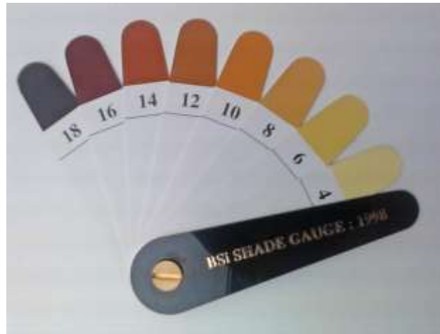
Şekil 4. 9 Hamurlu gıdaların pişmişliğinin ölçümünde kullanılan BSI renk skalası
