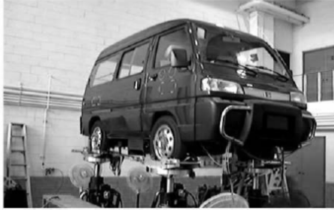
Şekil 1. 10 Laboratuvar test düzeneği. Araç yoldan toplanan verileri laboratuvar ortamında uygulayacak olan 4 servo-hidrolik aktüvatör üzerine yerleştirilmiştir[25]
