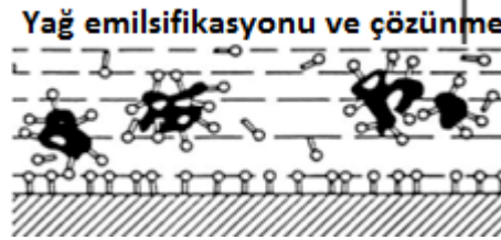
Kirin Yüzeyden Sökülmesi
