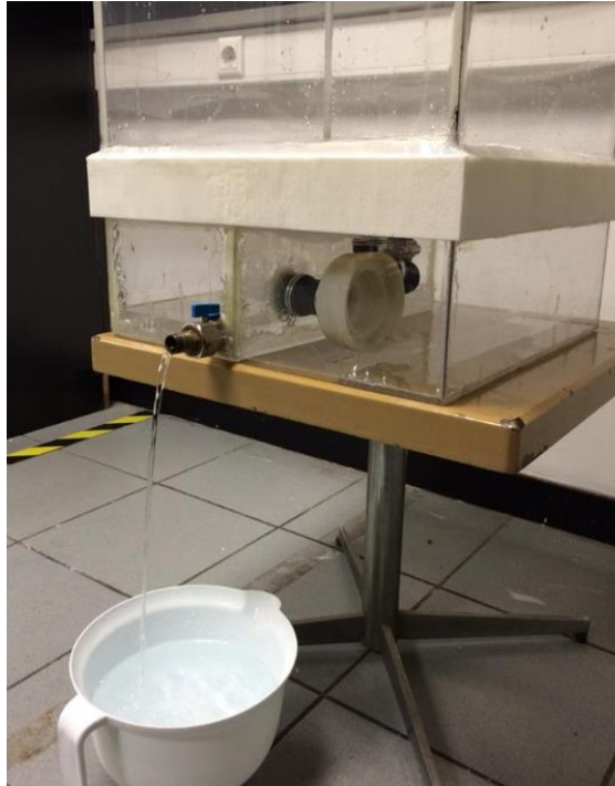
Şekil 6. 10 Pompa ve küresel vananın montajı
