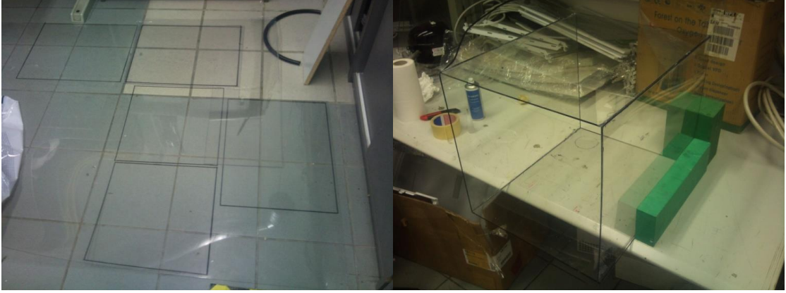
Şekil 6. 6 Malzemenin kesilmesi ve birleştirilmesi
