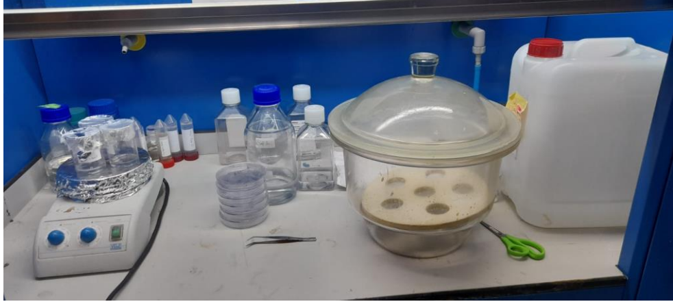
Şekil 3.10 Basımı tamamlanan örneklerin desikatörde çapraz bağlanması
