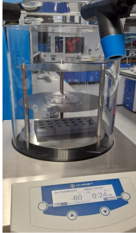
Şekil 3.16 Liyafilizatör cihazı ile kurutma işlemi
