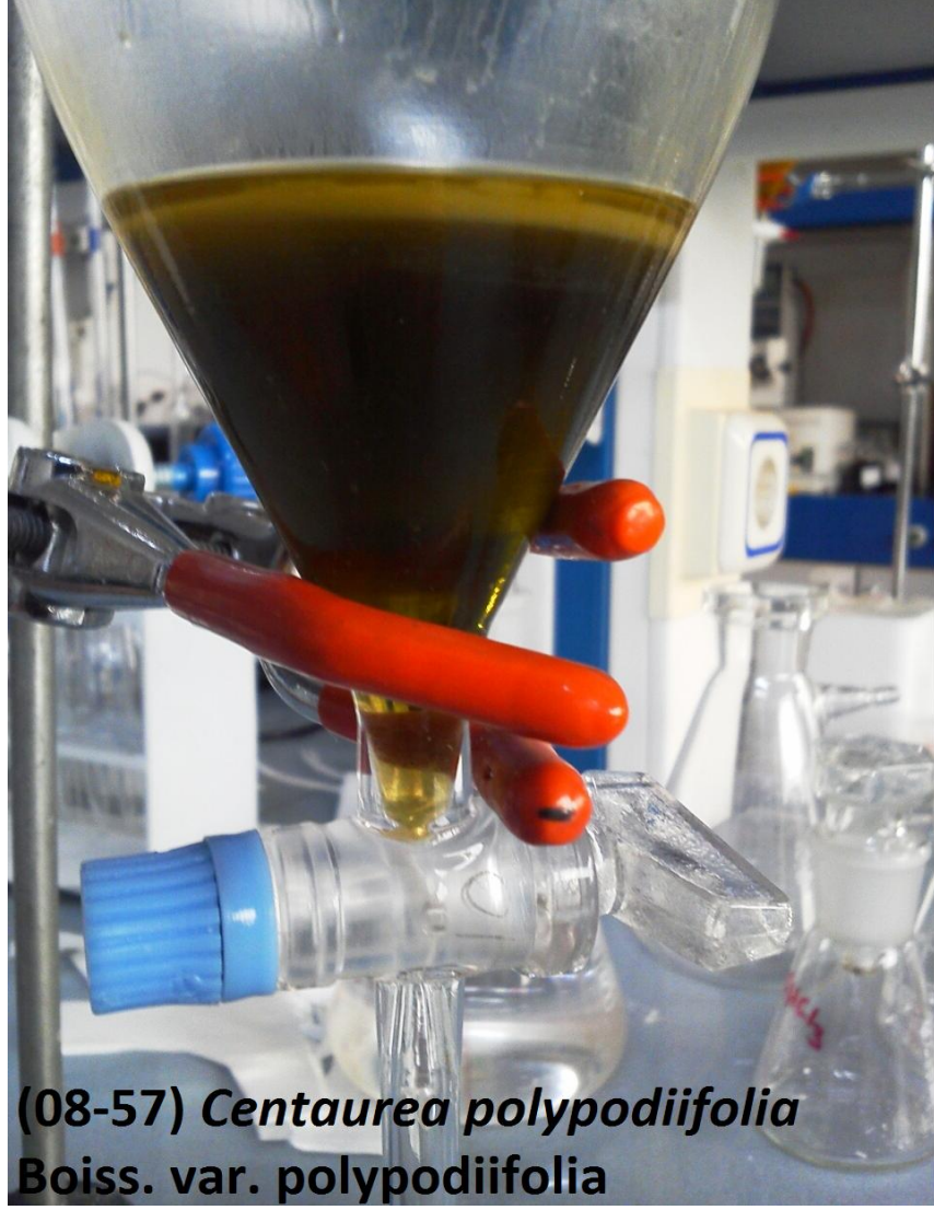
Şekil 3.2 Ekstrelerin ayırma hunisinde türevlendirilme aşaması
