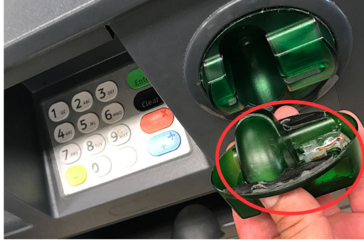
Şekil 2.1 Kart kopyalama amaçlı ATM'lerin kart giriş yuvasında kullanılan kart kopyalama aygıtı (skimmer) [15]
