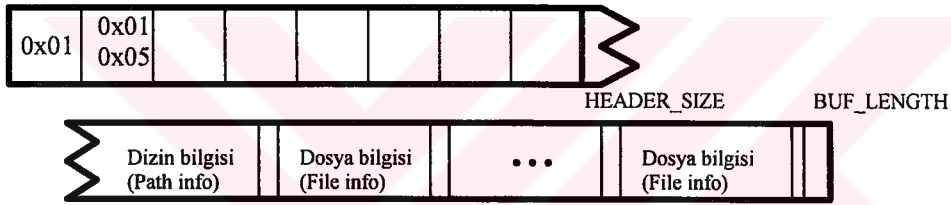
Şekil 6.9 FNSA'dan FNS'ye yollanan paketin yapısı, 0x01/0x05 tipi
