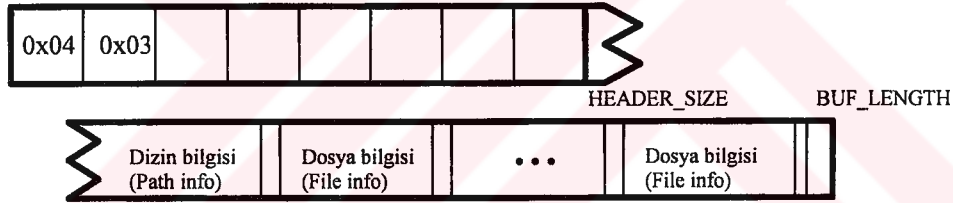
Şekil 6.7 FNS'den SFNS'ye yollanan paketin yapısı, 0x03 tipi
