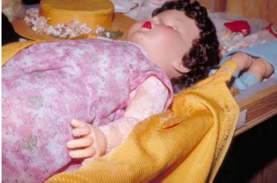
Resim 3: Polivinilklorürden üretilmiş oyuncak bir müze nesnesi yüzeyindeki katkı maddesi göçü
