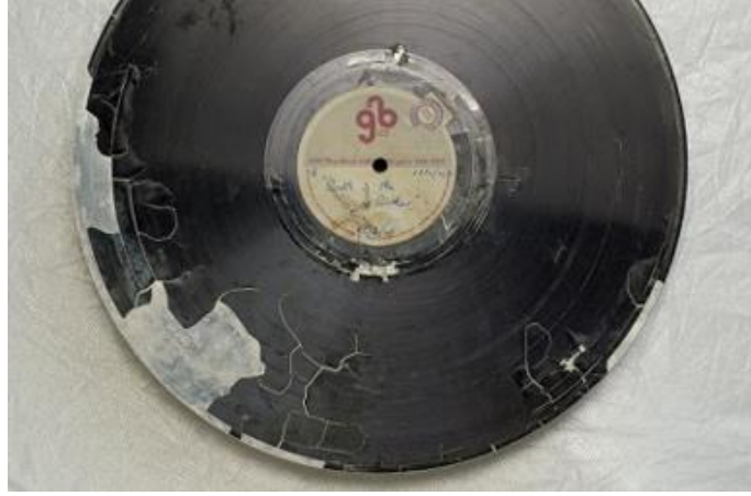
Resim 7: Selüloz asetat plak üzerinde gerçekleşen pul şeklinde dökülme
