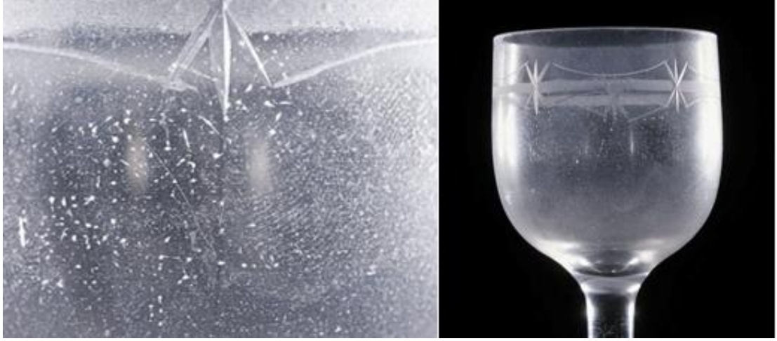
Resim 5: Yüksek bağıl nem seviyelerinde kararsız soda-kireç camında gözlemlenen sisli görünüm
