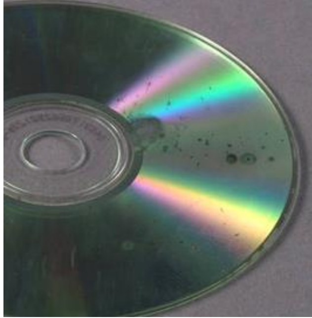
Resim 8: Yansıtıcı metal katmanda bağıl neme bağlı gerçekleşen oksitlenme sorunu
