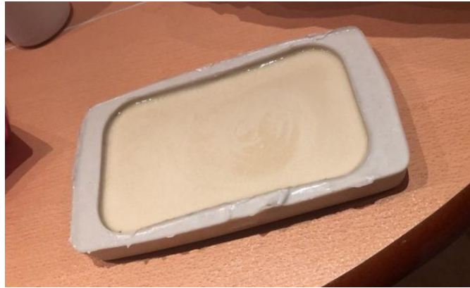
Şekil 32: RTV 2 Silikon Kalıp ve İçerisinde Poliüretan Reçine
