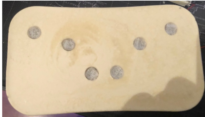
Şekil 34: İlk VBraille Filtre Sünger Yerleşimi
