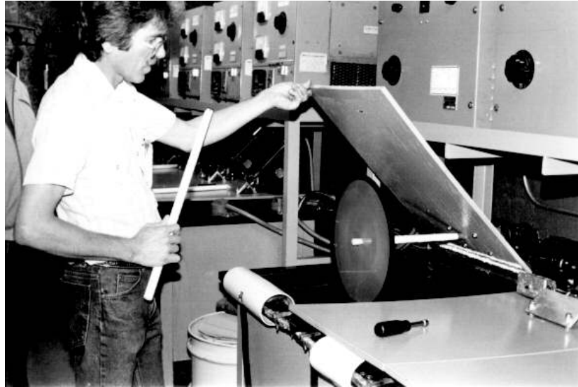
Şekil 2: Dönemin Plaklarının Lacquer Gümüş ile Kaplandığı Andaki Görüntüsü
