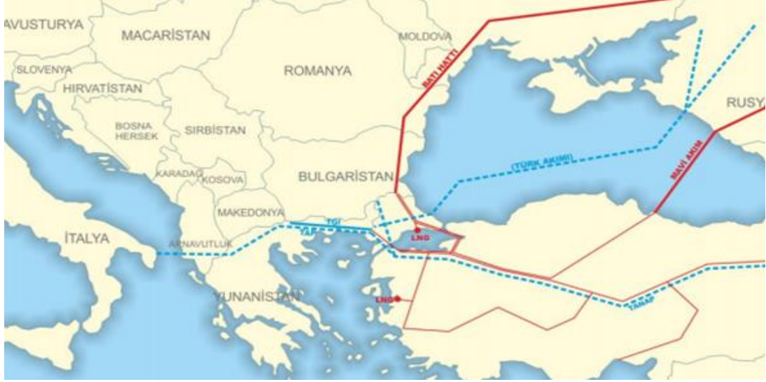
Şekil 5: Doğal Gaz Boru Hattı Projeleri
