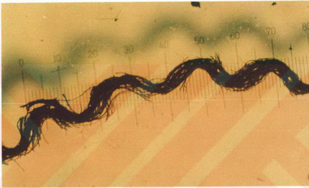
Şekil 32. Bizans dokumasına ait bir ipek lifin stereomikroskop altındaki görüntüsü ( \times 200 )
