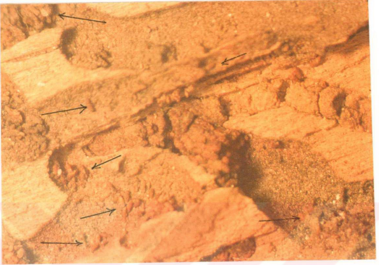
Şekil 13. Ahşabın oyuklarına bırakılmış parazit yumurtaları (ok)
