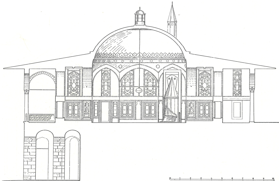
Şekil 4.3. Bağdat Köşkün Şematik Kesit (Eldem,1969).
