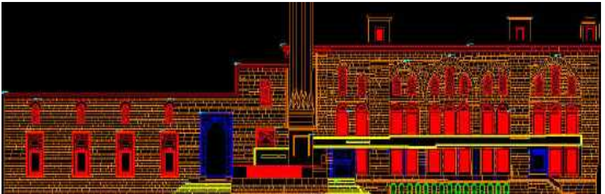
Şekil 3.31 Fatih Camii güneybatı cephesi çizimi (Yastıklı, 2005)
