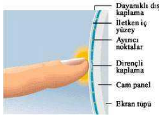
Şekil 2.9 Dirençli dokunmatik ekranlarda kullanılan kaplamanın yapısı [3]
